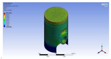
Figure 15. von Mises stress of the Piston
